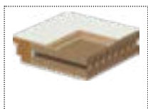
réteges szerkezetű betét (42 dB)
